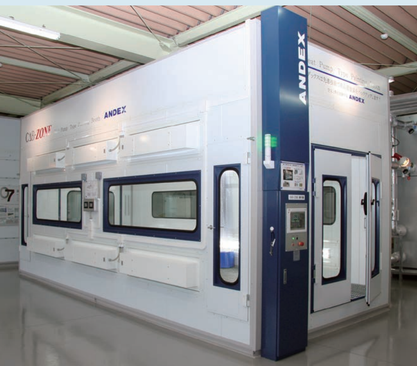
▲ ウェットエア方式採用の高空質 恒温恒湿塗装ブース「CAB-ZONE」
